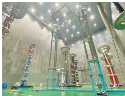
图18 816 kV 隔离开关试验姿态
