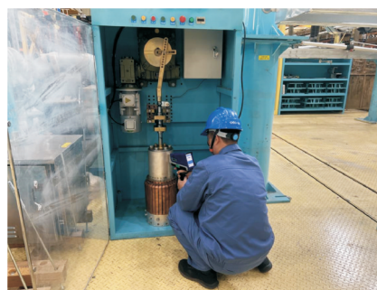
图2 816 kV高压直流隔离开关机械操作试验平台
